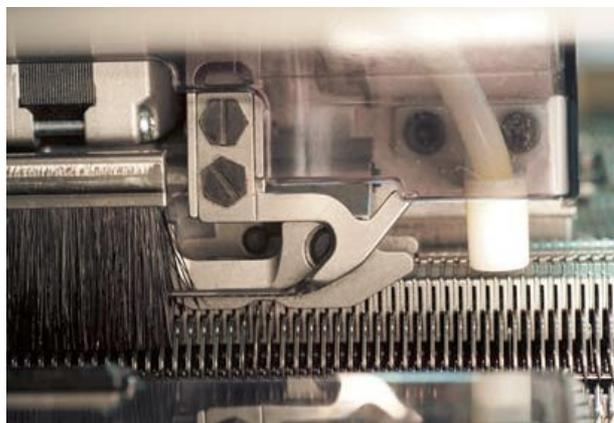
Оригинальная система прутковой оттяжки Shima предотвращает сброс петель (и прессование), возможный при подъеме игл во время вязания и переноса, в любом направлении прохода. Обеспечивает равномерную оттяжку при вязании полотна.
